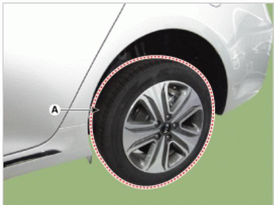
拆卸后车轮与轮胎时, 小心不要损坏轮毂螺栓。
